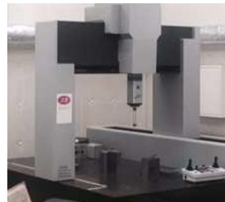
ステージ上のワークにプローブを当て、縦・横・高さから3次元座標を取得し、寸法・位置度・輪郭形状等を高精度に測定が可能。
